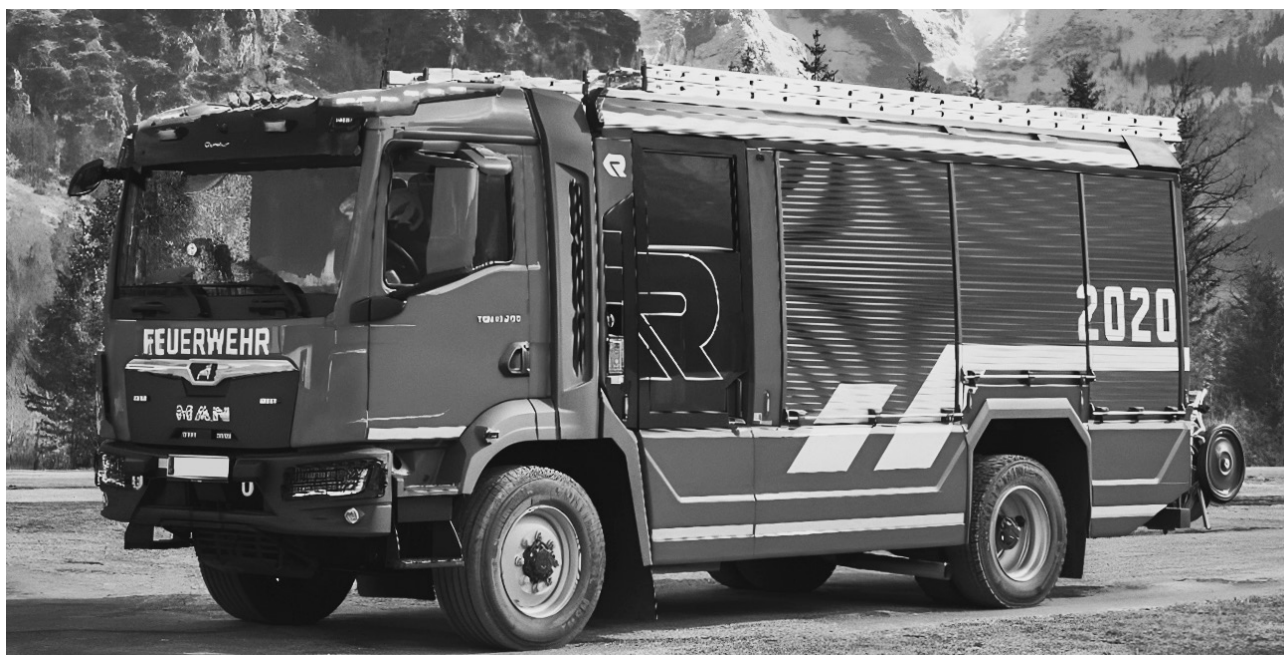
Rosenbauer-Tanklöschfahrzeug TLF 3000 AT Facelift mit integrierter Mannschaftskabine, aufgebaut auf MAN Fahrgestell Typ TGM 16.320, 4x4, Radstand 3'950 mm. (Beispielabbildung)
