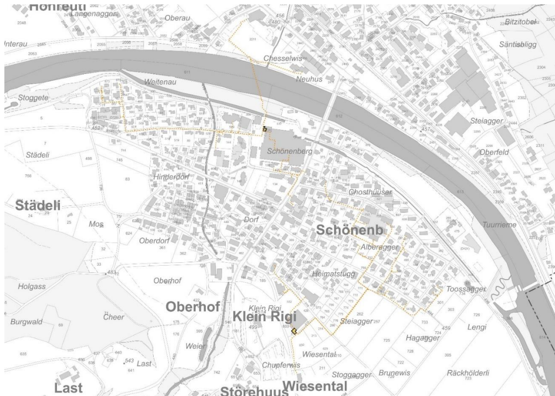
Abbildung 21: Fernwärme-Leitungen beide Wärmeverbünde
